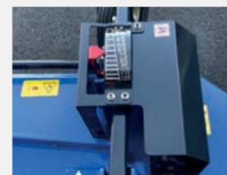
**RÉGLAGE ÉLECTRO HYDRAULIQUE DE LA HAUTEUR DE COUPE**
