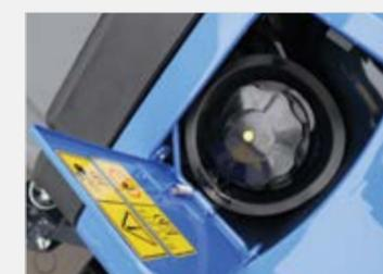
**RÉSERVOIR CARBURANT** Système de récupération de débordement
