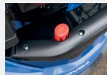
RÉGLAGE CENTRALISÉ DE LA HAUTEUR DE COUPE
