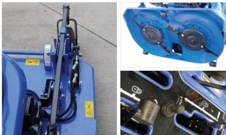
Le plateau de coupe 1,52 m est équipé de 2 disques avec chacun deux couteaux rétractables qui s'escamotent en cas d'obstacles. Ce système permet de protéger la transmission entièrement mécanique (pas de courroie) qui est animée par deux boîtiers renvoi d'angle en fonte extrêmement robustes.
