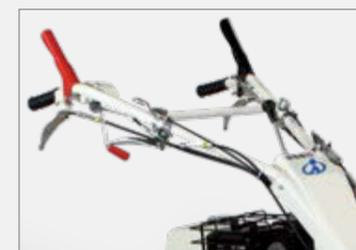
**GUIDON DÉPORTABLE ET RÉGLABLE EN HAUTEUR**
