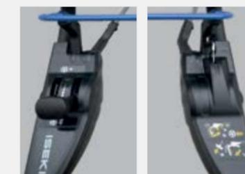
COMMANDES D'AVANCEMENT et d'embrayage frein de lame
