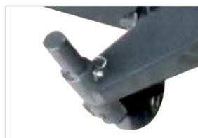
**ROUES DE JAUGE CAOUTCHOUC MONTÉES SUR GRAISSEUR**
