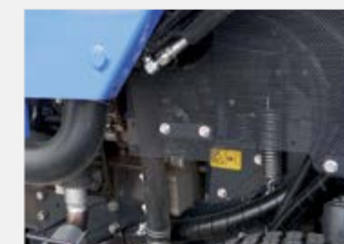
GRILLE DE FILTRATION AMOVIBLE Refroidissement transmission, accessoires et moteur
