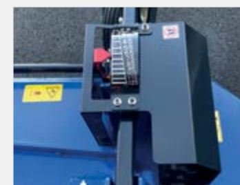
RÉGLAGE ÉLECTRO HYDRAULIQUE DE LA HAUTEUR DE COUPE d'origine sur plateau SF583H
