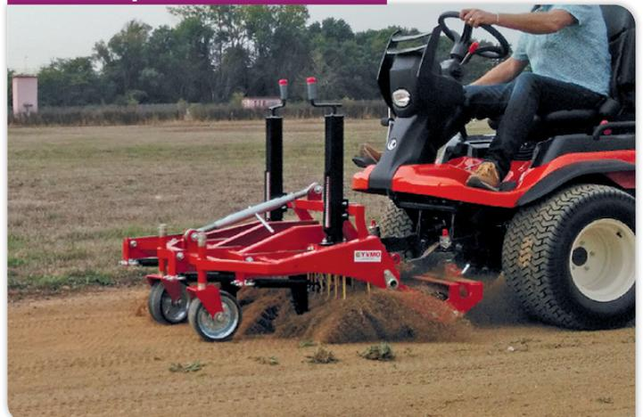
**RABOT DE PISTE** destiné à l'entretien des pistes et terrains stabilisés. Il permet simultanément un **décompactage superficiel, un reprofilage, un retassement des surfaces ainsi qu'un balayage de finition**, le tout à grande vitesse.
