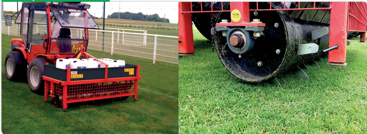
**TRAINE RIGIDE** pour les terrains engazonnés afin d'émettre les carottes de terres, enfouir les semences à la suite d'un regarnissage ou incorporer l'engrais ou du sable après apport.
