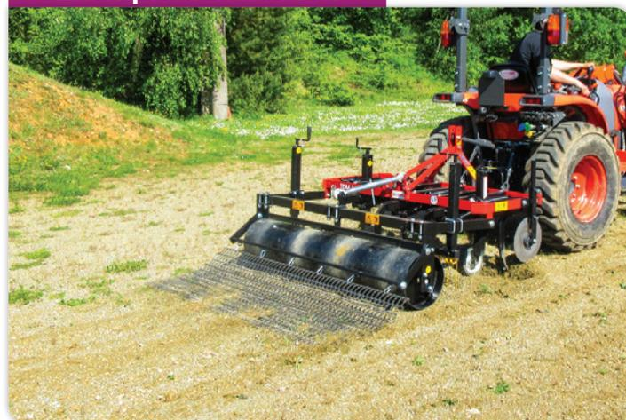
**DÉSHERBEUR MÉCANIQUE FRONTAL**, conçu pour désherber des surfaces sablées, stabilisées et gravillonnées (allées paysagères, pistes, parkings, voies vertes, cimetières) des plus souples aux plus dures.
