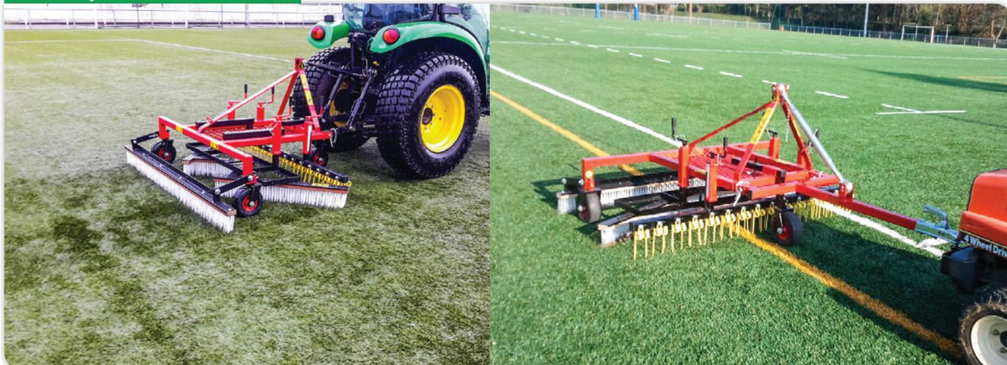
**TRAÎNE DE BALAYAGE** pour le décompactage et le balayage destinée à l'entretien hebdomadaire et rapide des gazons synthétiques avec granulats de caoutchouc.
