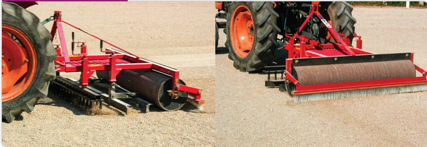
**BARRE MULTIFONCTIONS** robuste et ultra-polyvalente permettant d'accomplir de nombreux travaux : nivelage, ratissage sur les allées gravillonnées, désherbage, défeutrage des gazons, ratissage des branches ou aiguilles de pin, réglage de la terre des taupinières, décompactage d'un terrain en gazon synthétique etc. L'addition d'un essieu (en option) permet un réglage précis de la profondeur de travail.
